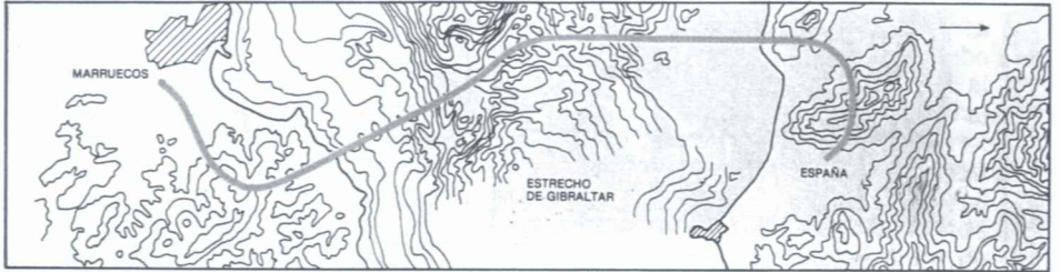
Possible trazado del túnel bajo Gibraltar, de acuerdo con los estudios realizados.
