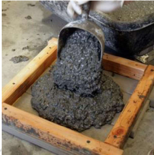
Imagen 37. Textura y consistencia del hormigón geopolímero
